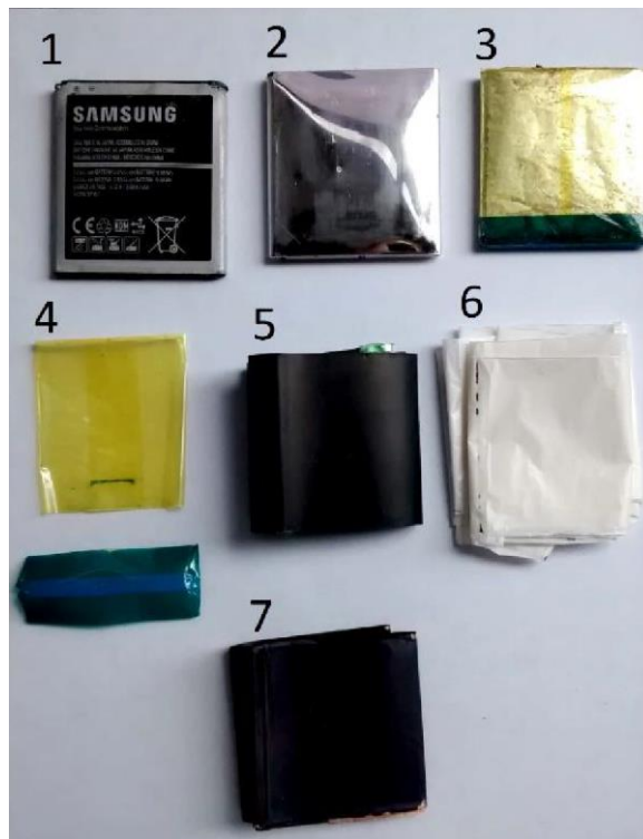
Desmantelamiento batería ion-litio Samsung referencia 11CP6/57/61.
