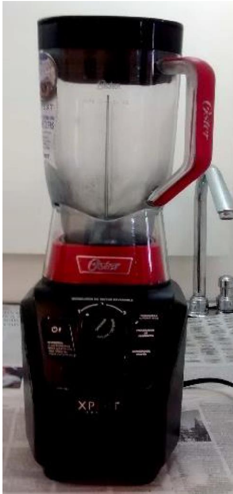
Licadora industrial de 500W utilizada para triturar el material catódico de las pilas usadas.
